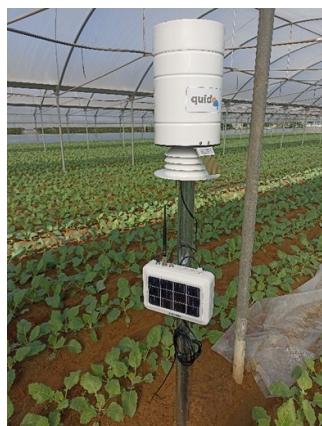
Figura 2. Stazione agrometeorologica Quido by NESA Srl. Sistemi pronti all'uso di facilissima installazione, inviano i dati direttamente in Cloud tramite tecnologia narrowband 4.0. Non necessitano di alcuna configurazione e i dati sono immediatamente disponibili su web e su APP per dispositivi mobili. Permettono di tenere sotto controllo parametri specifici come temperatura, umidità dell'aria, bagnatura fogliare oraria, precipitazione cumulata ed umidità del terreno. I dati rilevati alimentano modelli per il monitoraggio di patogeni chiave individuati su ciascuna coltura.
